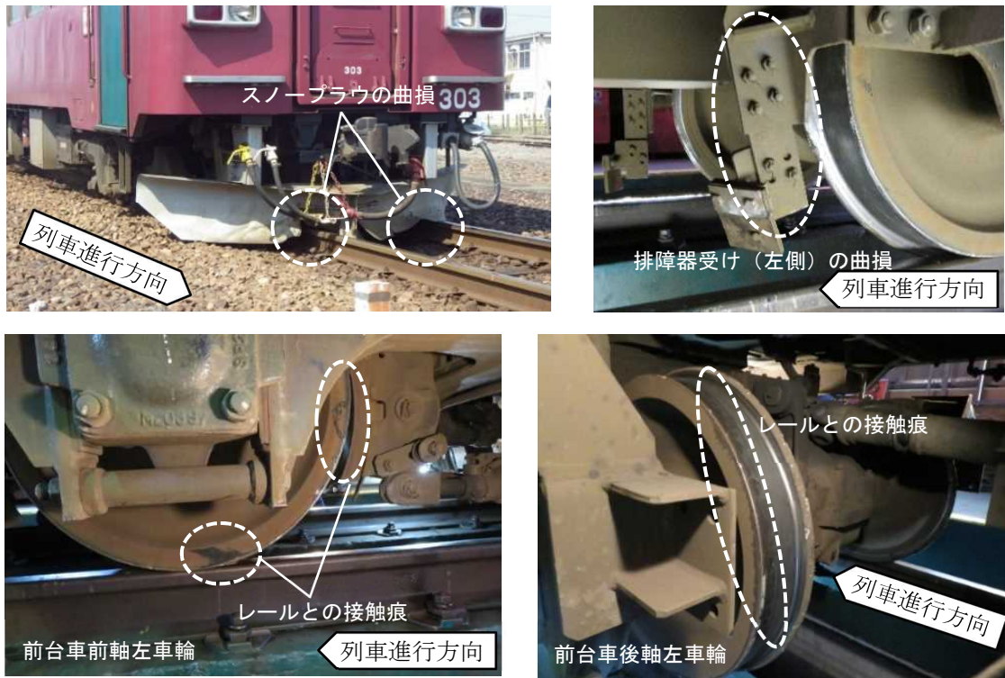
図 1.1 本件車両の損傷及び痕跡
