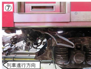
⑦ 前面スカート損傷
