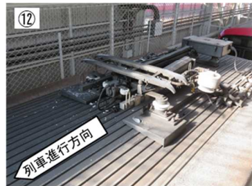
パンタグラフ損傷
