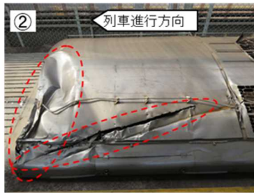
② 空調装置損傷
