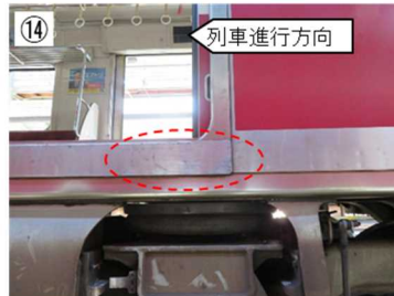
左側面後部損傷
