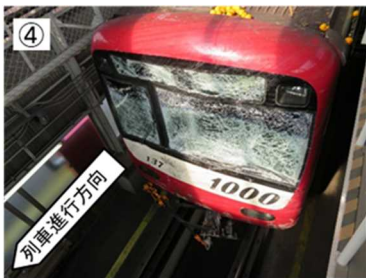
④ 前面窓ガラス損傷
