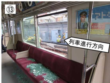
右側面窓ガラス損傷
