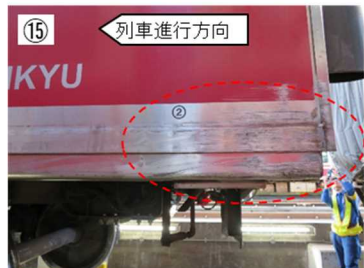
左側面後部損傷
