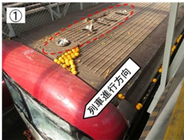
① 列車無線アンテナ損傷
