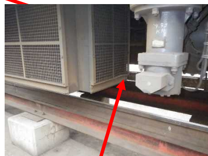
1両目 冷却装置のカバーのへこみ
