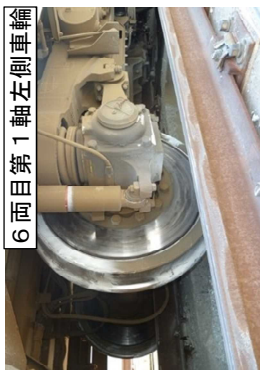
付図5-3 本件列車の脱線状況(3)
