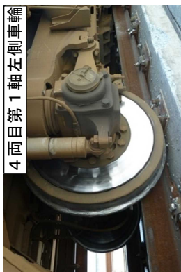
付図5-2 本件列車の脱線状況(2)
