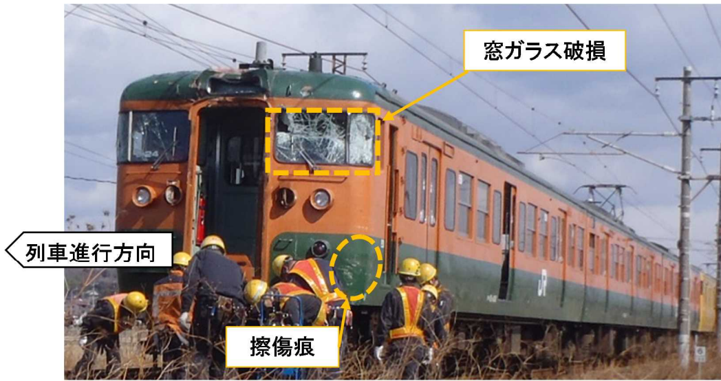
写真3 車両の損傷状況
