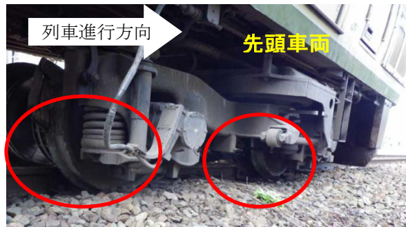
前台車第1軸及び第2軸 右に脱線
