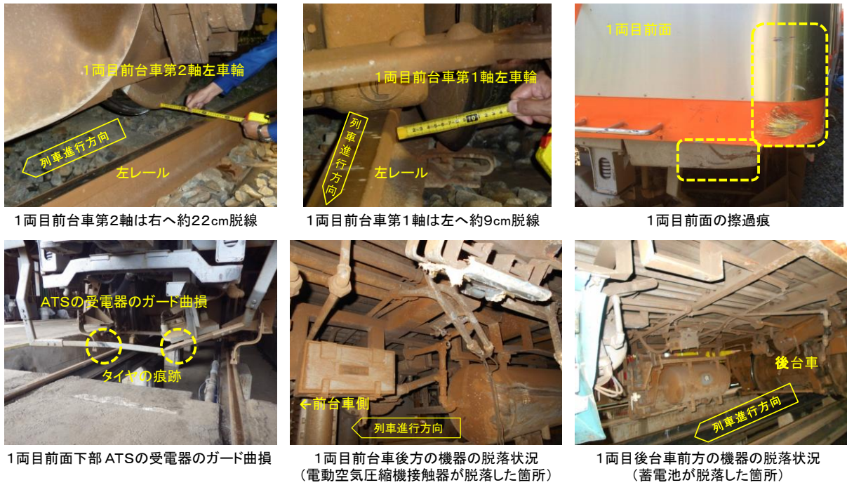
付図5 列車の脱線及び損傷の状況
