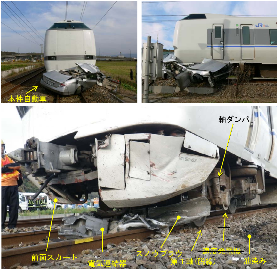
付図9 脱線状況
