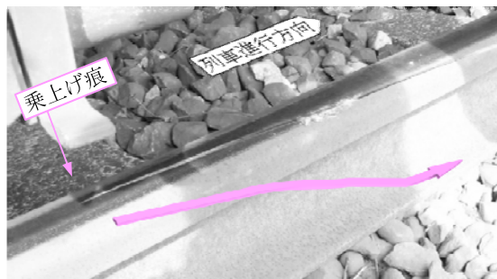
右レール上の乗り上げ痕と脱線(脱輪)の痕跡 (2k207m付近)
