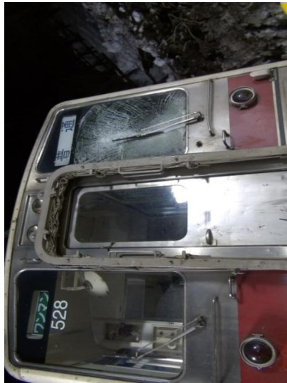
運転士室前面ガラスの破損、ワイパーの曲損
