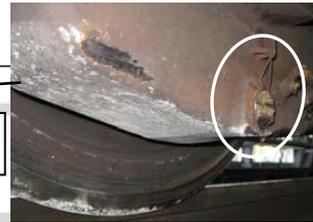
⑨No. 2 駆動装置排油栓損傷
