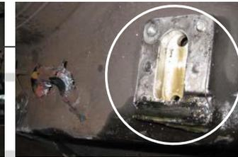
①No. 2 駆動装置油面計破損
