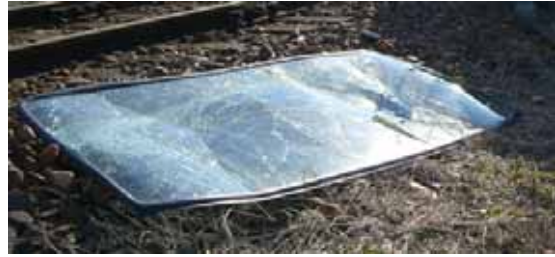
衝突時の衝撃により外れた フロントガラス (事故発生時撮影)
