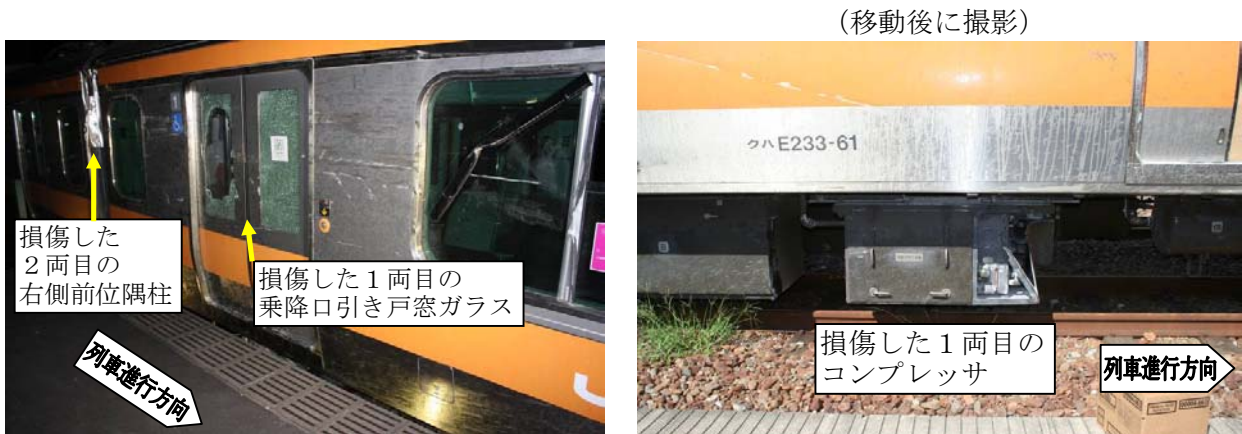
写真4 車両の損傷状況
