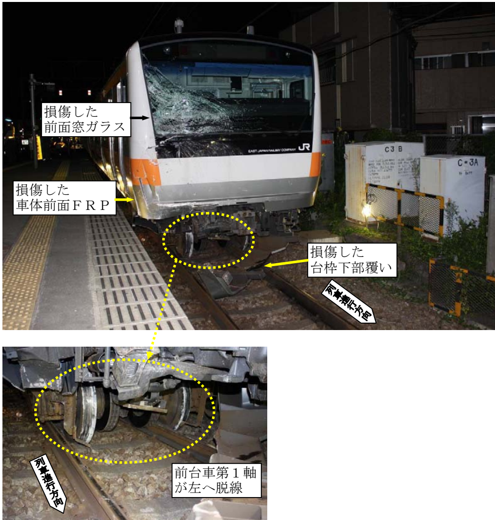
写真3 脱線状況と車両の損傷状況
