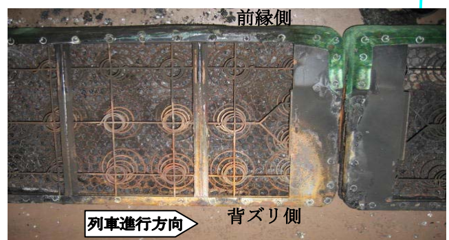
座席付近の焼損状況（座布団を外して裏返した状態）
