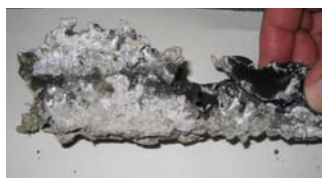
窓ガラスの破片と一緒に固まったと見られるアルミ塊
