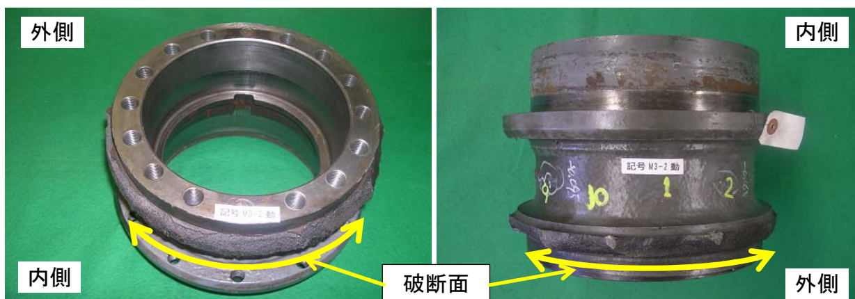
付図9 本件ハブの状況・ボス側（その1）
