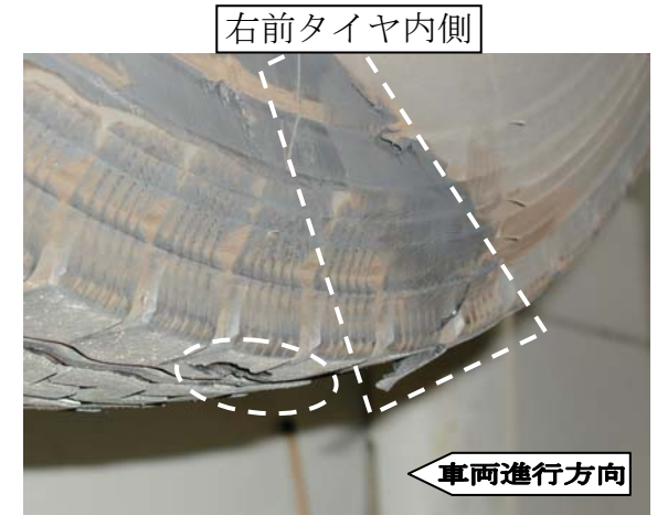
亀裂及び擦過痕
