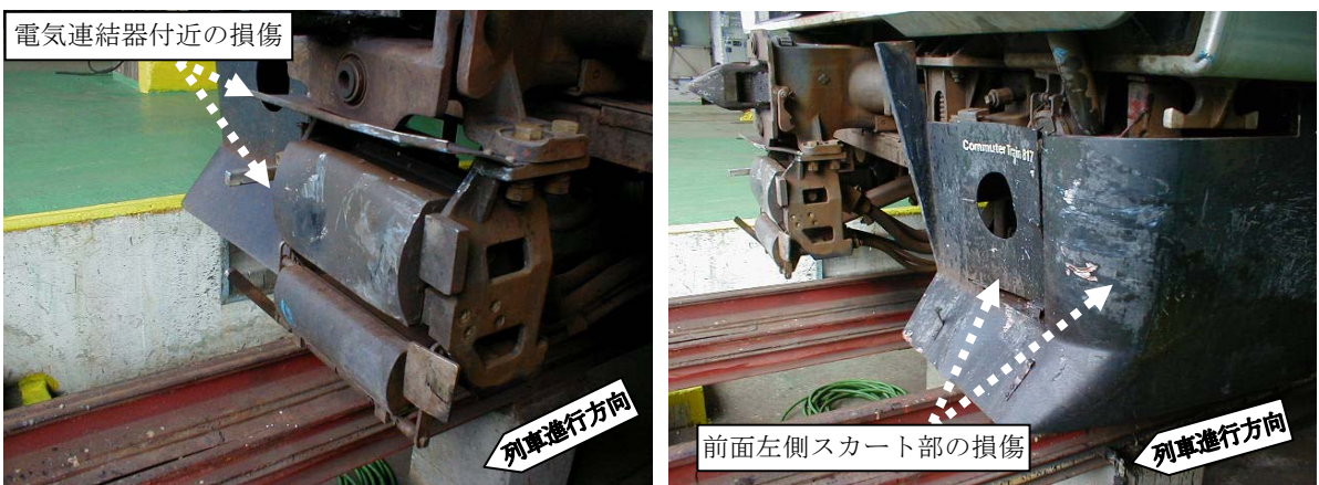
写真3 車両の損傷状況
