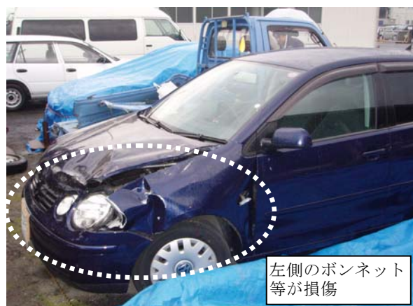
写真5 乗用車の損傷状況
