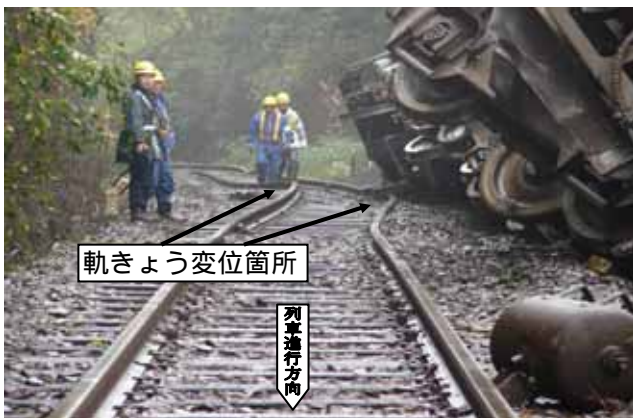
写真2 脱線現場の軌道状況
