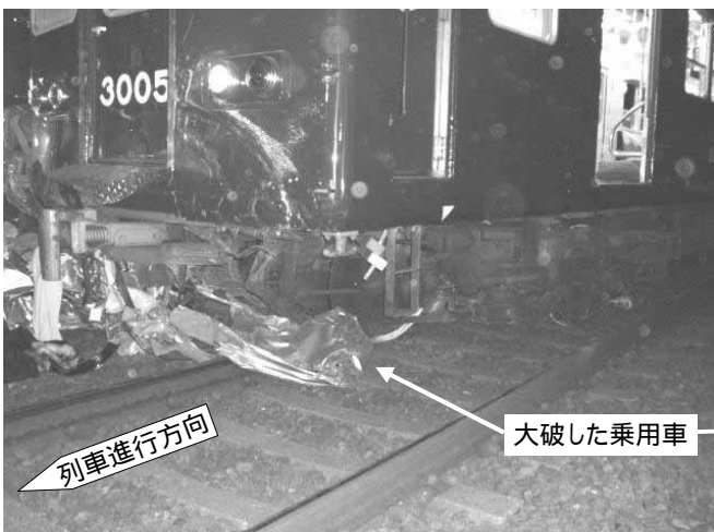
写真3 車両の脱線状況
