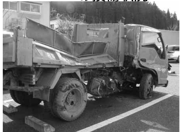
写真6 小型ダンプカーの損傷状況
