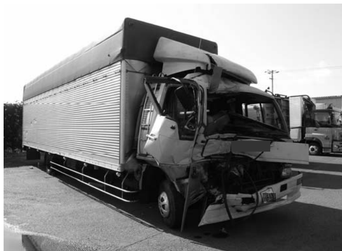
写真4 中型トラックの損傷状況
