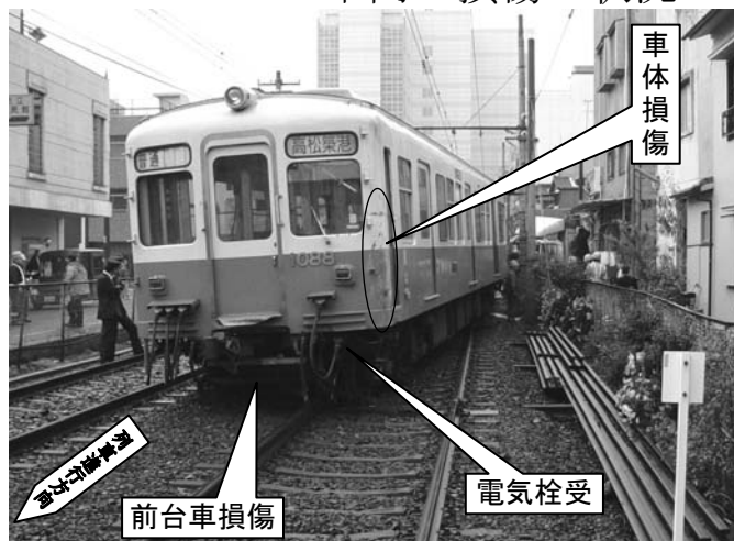
写真3 脱線現場及び 車両の損傷の状況
