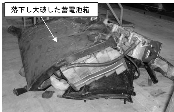
写真5 蓄電池箱の損傷状況
