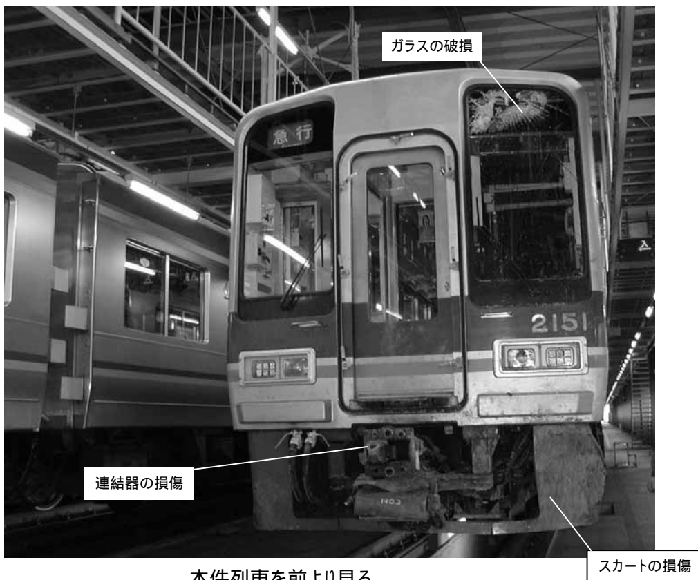
本件列車を前より見る
