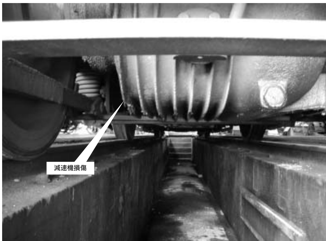
写真6 車両の損傷状況(2)
