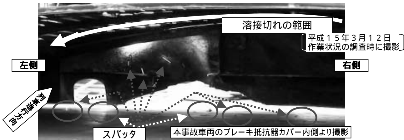
写真11 溶接中のスパッタ等の飛散状況
