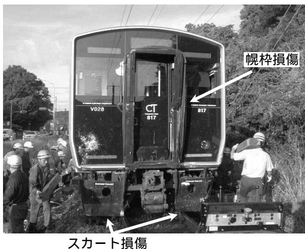
写真5 車両の損傷状況(1)
