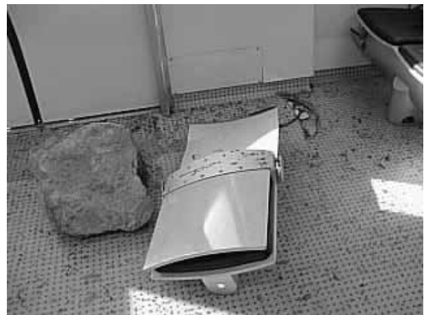
写真4 飛び込んだ石と折り畳み式座席の状況
