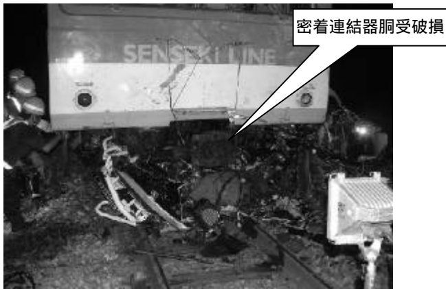
写真1 脱線現場の状況(1)
