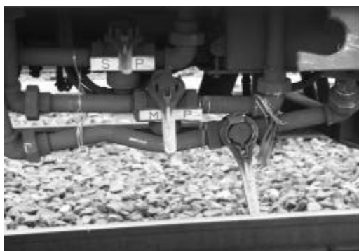
写真5 車両の損傷状況(2) (ブレーキ管損傷)
