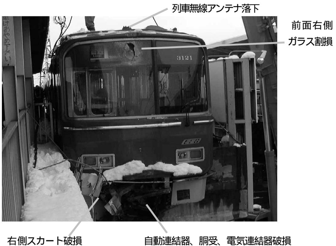
写真5 車両の損傷状況（その2）
