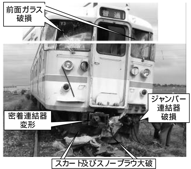
写真4 列車前部の損傷状況
