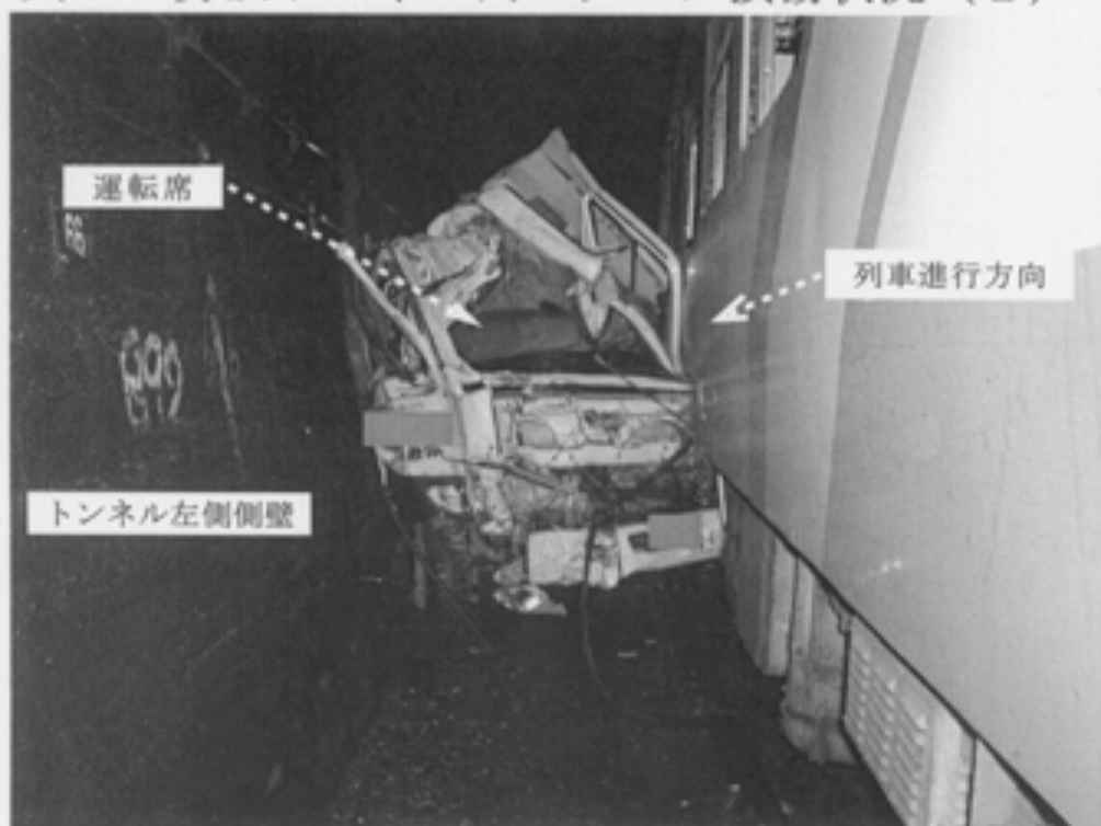
写真2 勢坂トンネル内のダンプ損傷状況（2）
