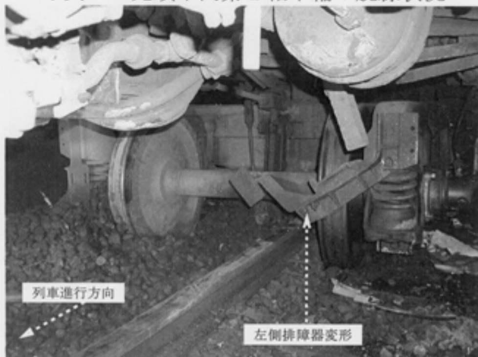
写真3 先頭車両第1軸車輪の脱線状況
