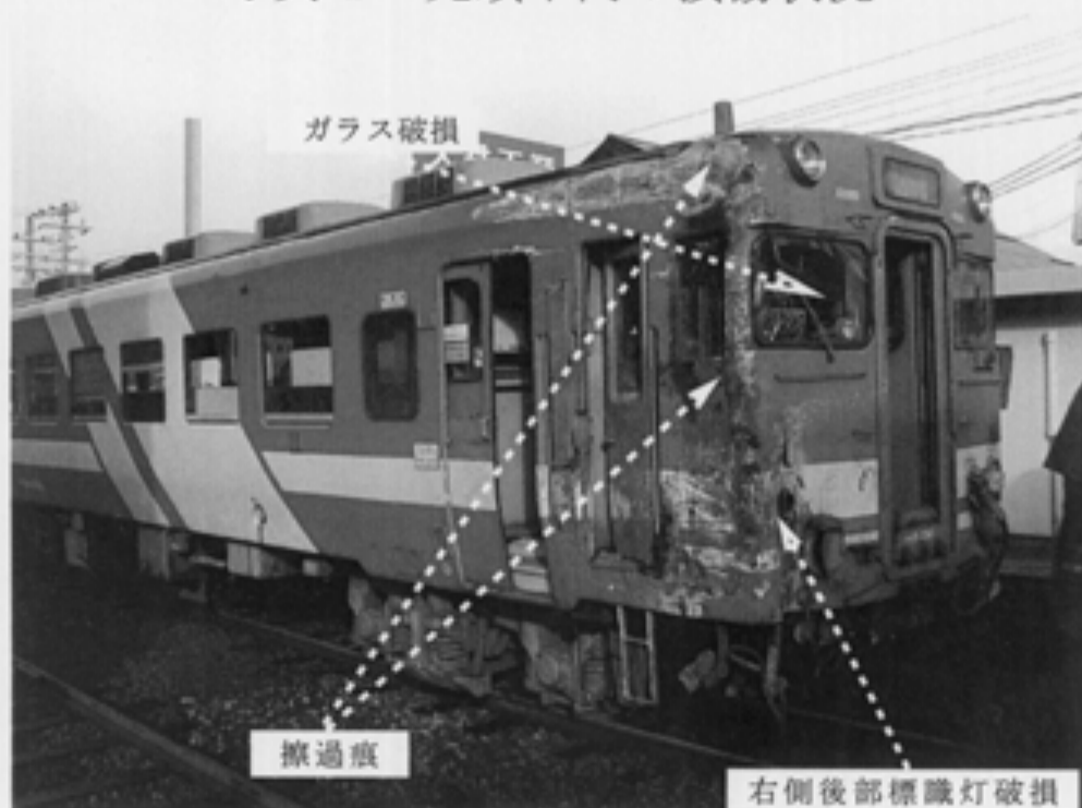
写真4 先頭車両の損傷状況
