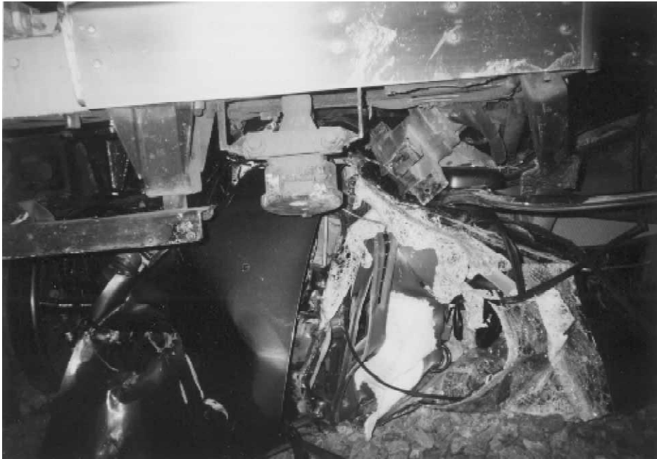
写真1 先頭車両に巻き込まれた軽自動車の損傷状況
