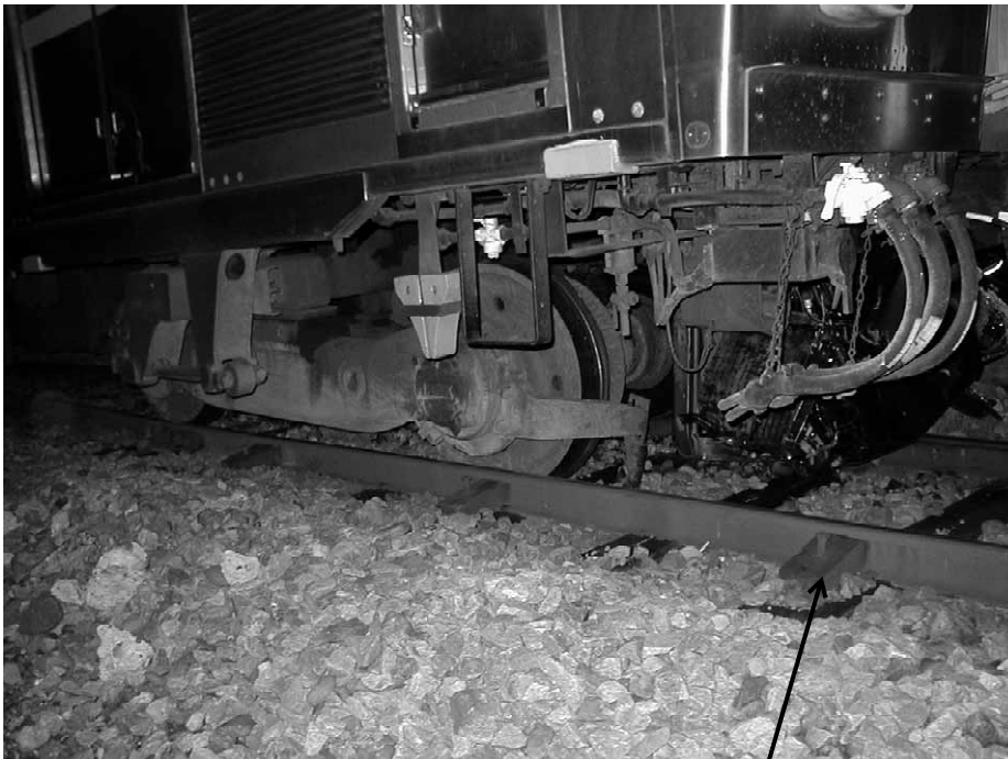
写真2 先頭車両の前台車第1軸右側車輪の脱線状況
