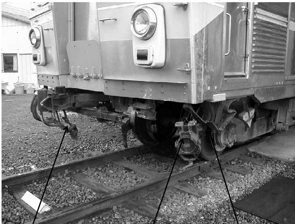
写真3 先頭車両の損傷状況(1)
