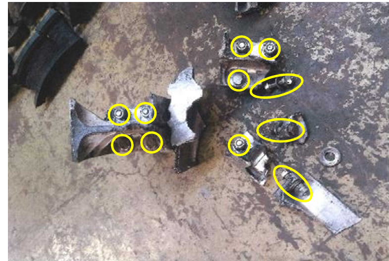
各ピースを固定していたボルト・ナットは 規定トルクで締付けられていた
