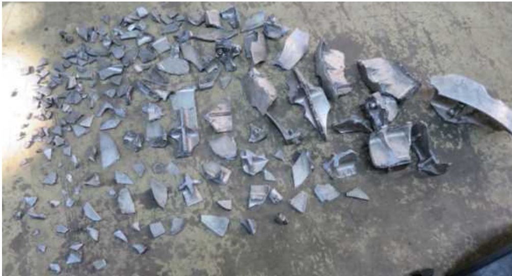
回収したNo. 2 走行輪の中子破片
