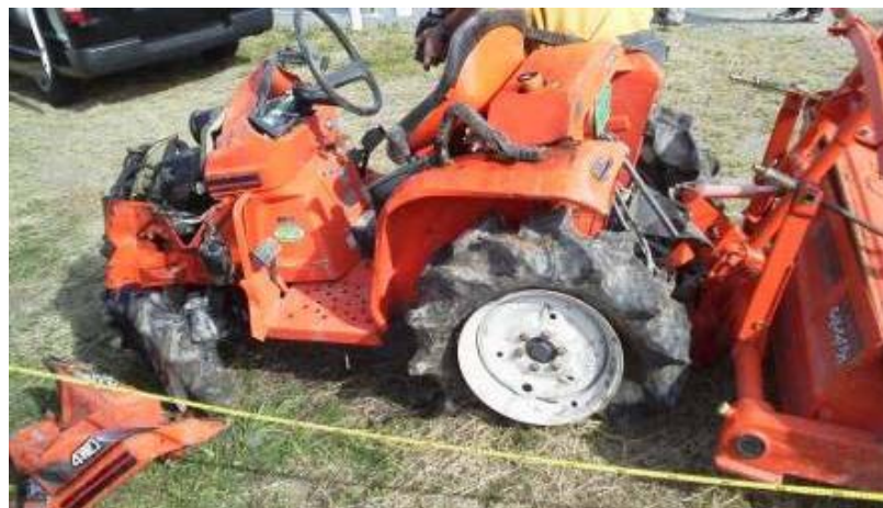
トラクタの損傷状況 (事故後に組み立てたもの)
