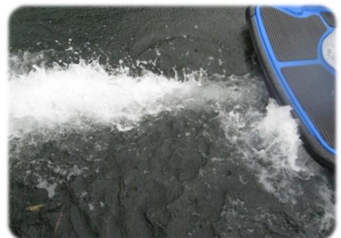
水上オートバイ後部の噴出口から排出されるジェット噴流
