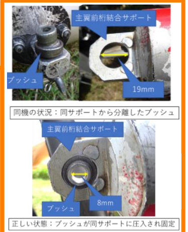
図5 摩耗により主翼前桁結合サポートからプッシュが分離
