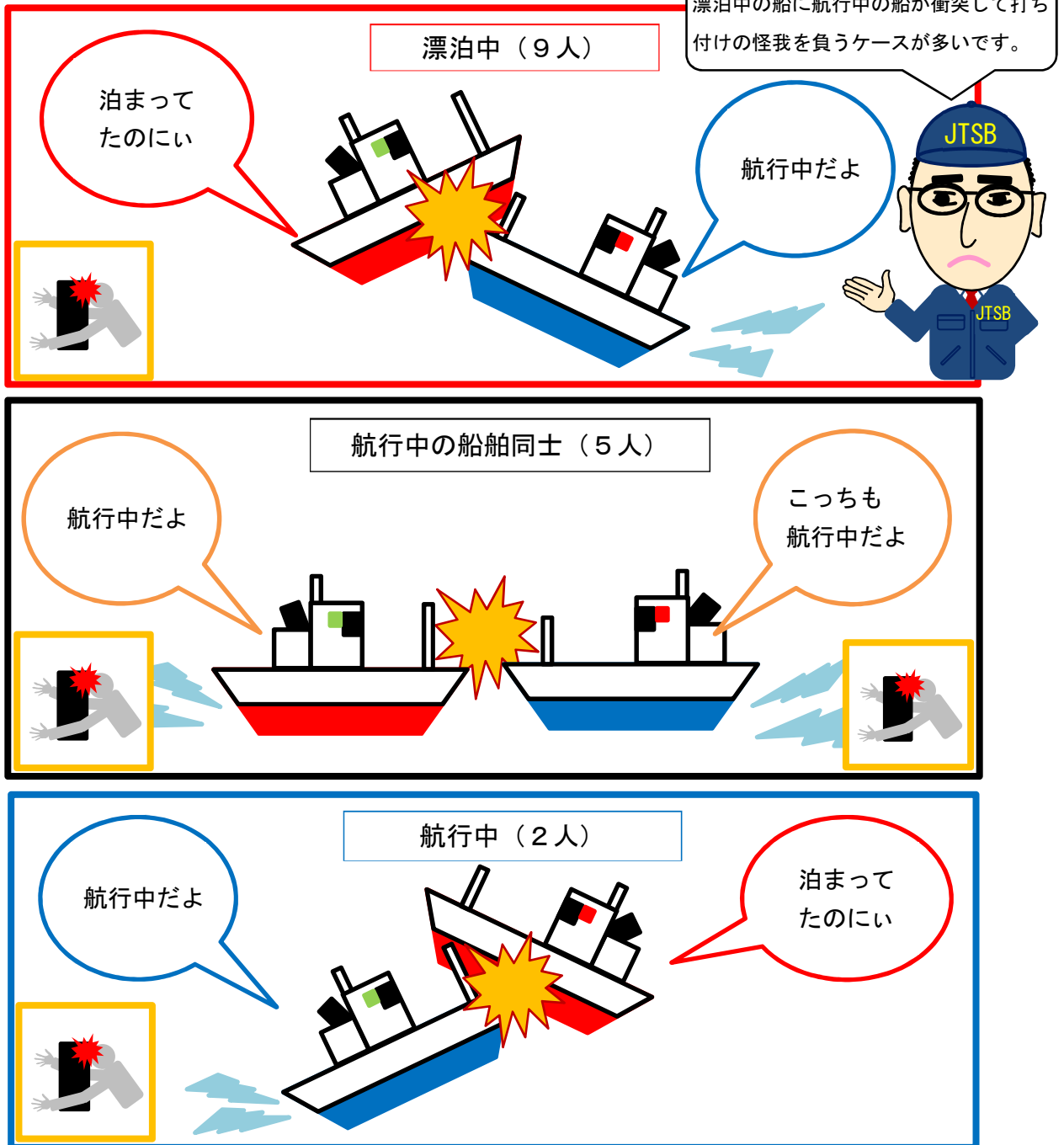
図11 2船間の衝突状況
