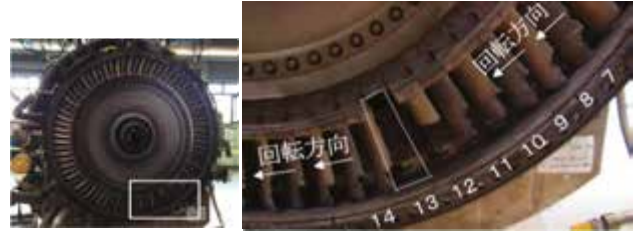
HPT2段目ブレード(左)と13番ブレードを起点とした損傷(右)
