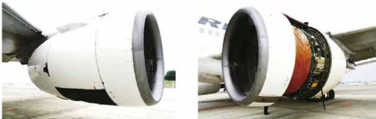
図5 エンジン・カウルの損傷状況
