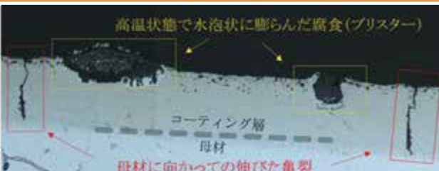
破断起点付近のコーティング層断面(上)とP03型TA部の形状(右)
