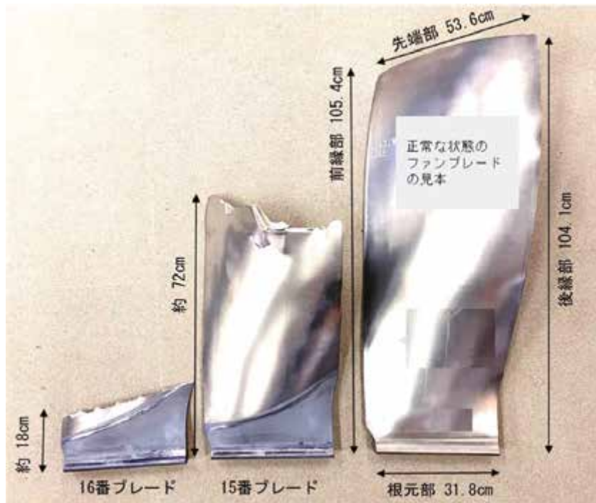
図2 ファンブレードの破損状況
