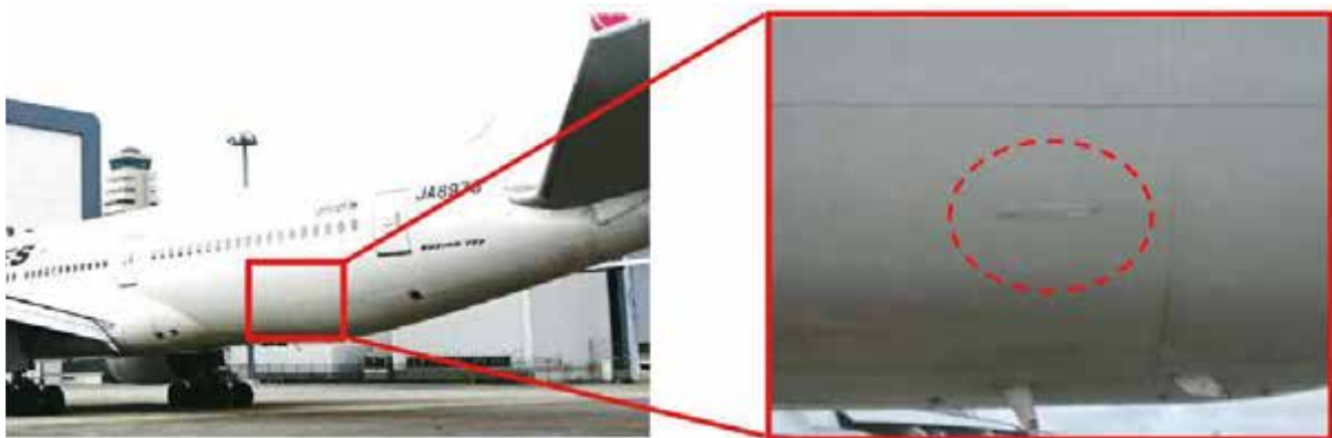
図7 胴体の損傷状況
