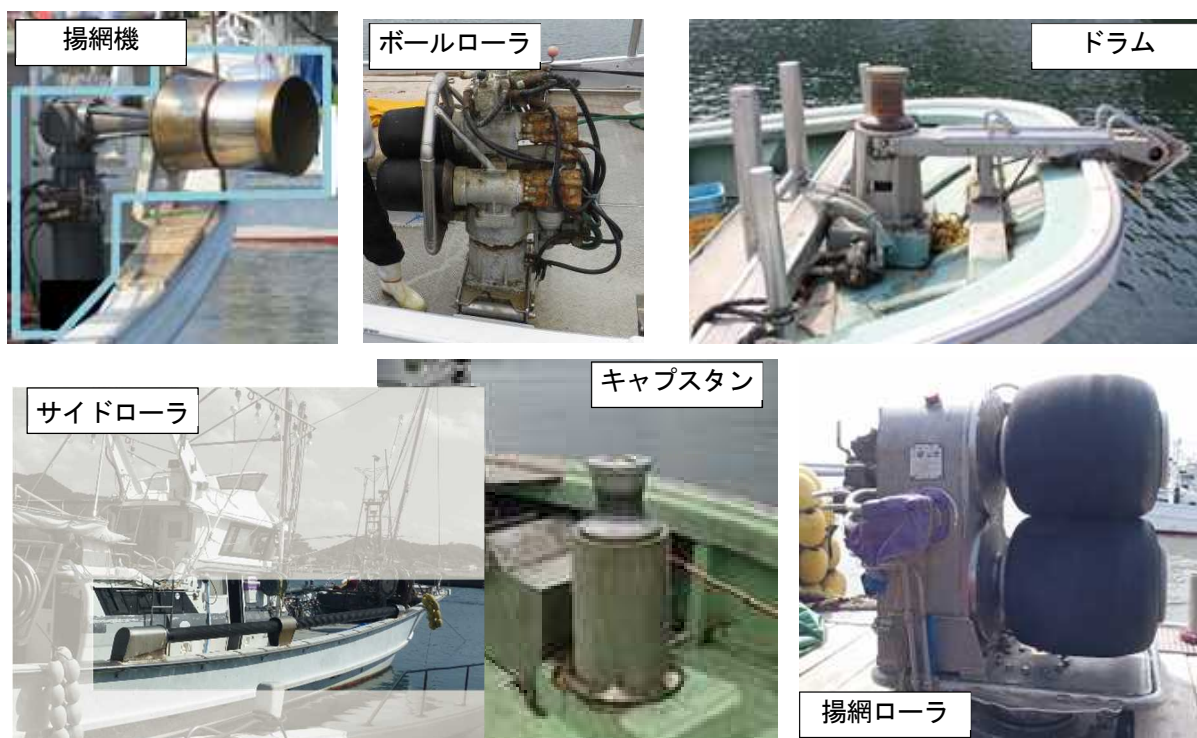
図3 揚網機等の例（事故調査報告書より）
