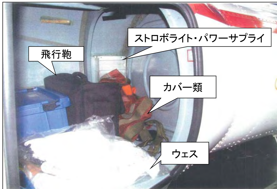
写真6 同型機の後部荷物室内(事故機と同じ積載状況)
