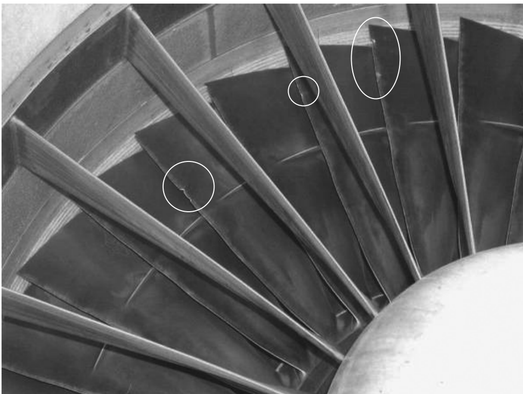
Photo 7 Fan Blade Damages
