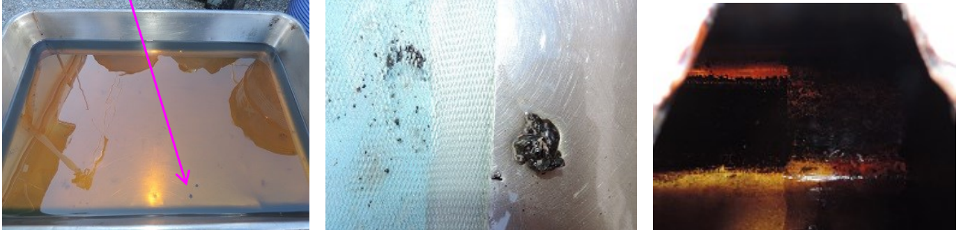
燃料油タンクから抜き出した軽油
