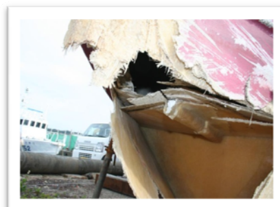
破口した船首船底部
