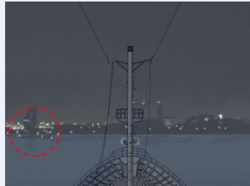
図15 陸岸の明かりに紛れるかき筏の簡易標識灯イメージ
