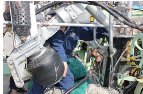
【ボールローラに巻き込まれた状況を再現】
