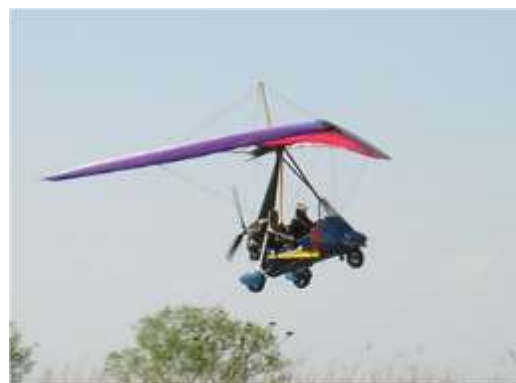
超軽量動力機の例(左:舵面操縦型 右:体重移動操縦型)
