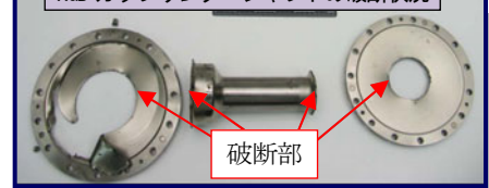
RGB カップリング・シャフトの破断状況
