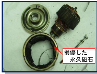
損傷したフェザリング・ポンプ用モーター
