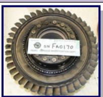
損傷した HPT ブレード
