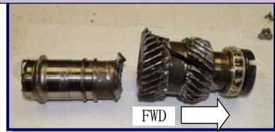
RGB ヘリカル・インプット・ギアシャフト破断状況
