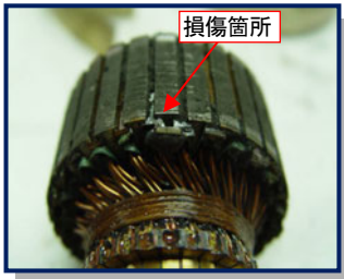
損傷した電機子
