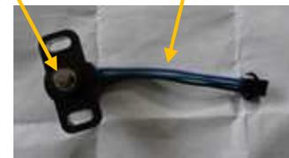
**B船**は、自動操舵で航行中、**自動操舵装置の設定した針路が左方又は右方にずれていた不具合が**みられ、リモコンの内部にある‘**舵角ツマミの舵角信号を自動操舵装置に知らせる抵抗器**’（以下「ポテンショメータ」という。）とポテンショメータに繋がっている電圧を変化させる信号を送る電線との**接触不良**があることが分かり、両方の交換が行われた。
