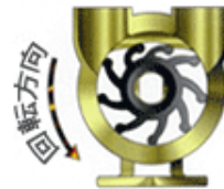
主機冷却海水ポンプ ゴム製インペラ概略図
