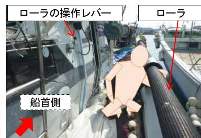
漁労長のゴム手袋の指先部分が揚収中の網と回転している船尾側ローラとの間に挟まれ、その後、左手に続いて左腕が巻き込まれた。
